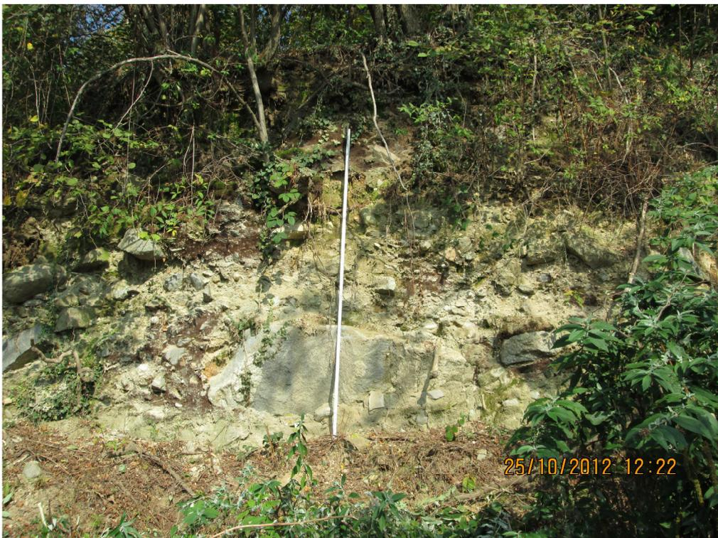
Foto n.8 Lungo un intaglio naturale sono evidenti le caratteristiche del terreno, si tratta di deposito fluvio-glaciale formato da ciottoli e blocchi immersi in abbondante matrice sabbioso ghiaiosa
