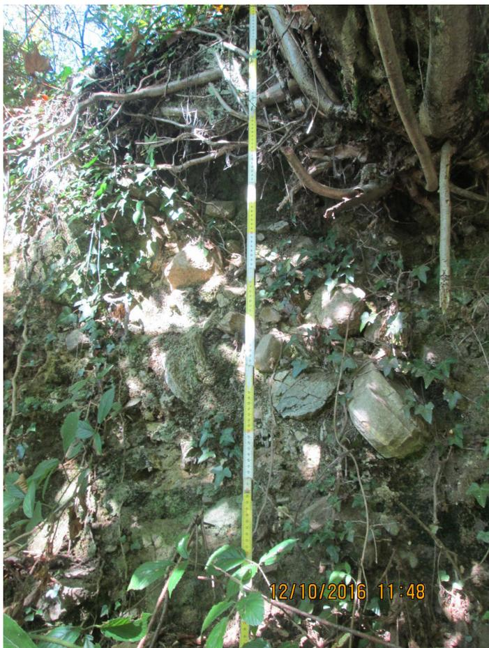
Foto n.5 Stratigrafia del terreno lungo una sezione esistente. Il terreno sabbioso ghiaioso è presente a partire dalla base della copertura di suolo avente uno spessore medio di 50 cm
