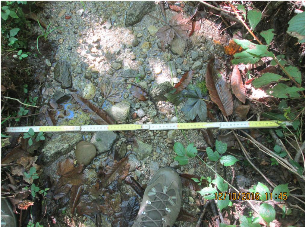
Foto n.3 L'alveo evidenzia la tipologia del terreno formata da ciottoli e blocchi immersi in abbondante matrice sabbioso ghiaiosa. Parte di questo terreno andrà asportato affinché aumenti la sezione di deflusso
